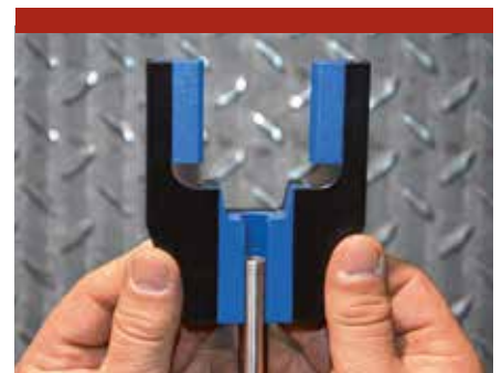
Montagevorrichtung ist fertig präpariert und wird durch Aufschieben mit dem Trägerpin verbunden. La dima di montaggio è pronta per essere infilata sul perno del montante.
